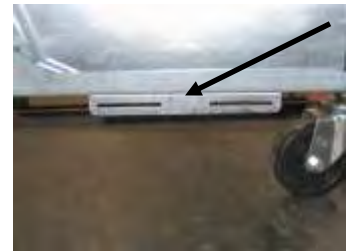
Abbildung 1: Befestigen Sie Ausrichtungshalterung am Boden der ATO-Gehäusestrebe.
