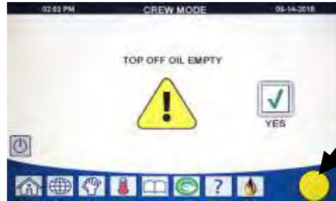
Abbildung 3 Gelbe Anzeige bei leerem Fettbehälter.
