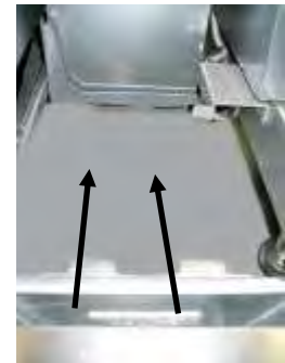
Abbildung 2: Die Schmelzeinheit im Schrank positionieren und die Zungen in die Ausrichtungs-Führungsschlitze einführen.
