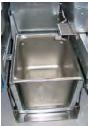
Abbildung 3: Die innere Fettbehälterwanne in die Schmelzeinheit einsetzen.
